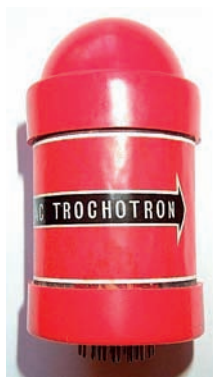
Figura 3. Válvula "Trochotrón" VS10G de Hivac. Cortesía de Jeremy M. Harmer, ( www.tubecollector.org )
