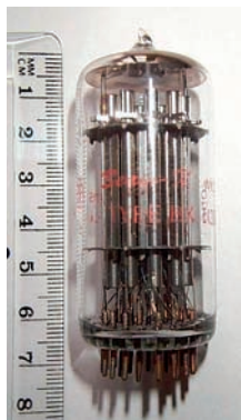
Figura 2. Válvula "Beam-X switch" BX1000 de Burroughs Co. Cortesía de Jeremy M. Harmer, ( www.tubecollector.org )
