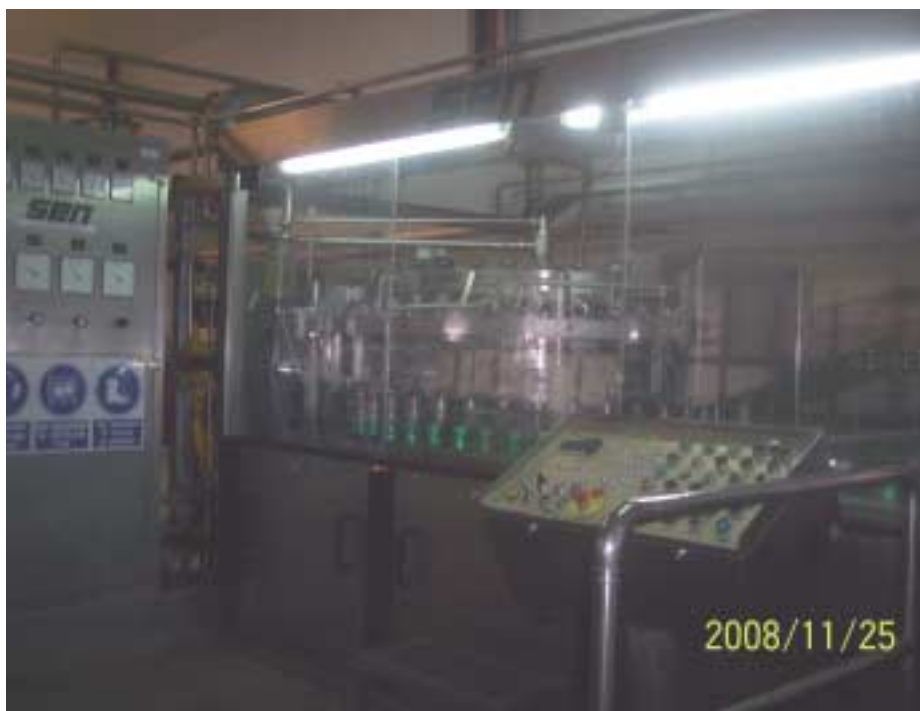
Figura 3: Llenadora de latas en funcionamiento.
