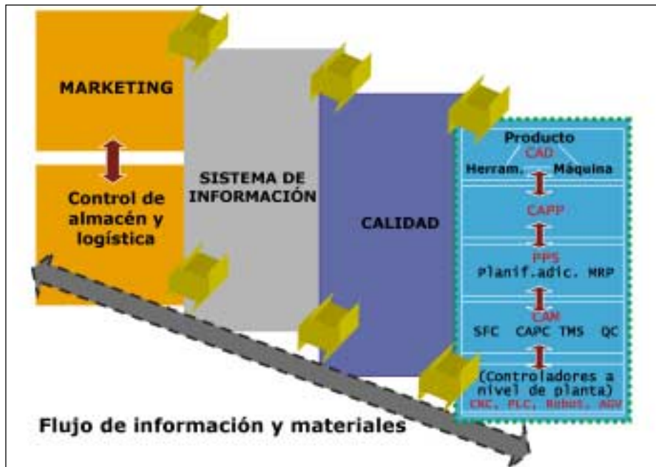
Figura 4. Relación integrada de las principales áreas dentro de la empresa necesarias para realizar la fabricación de un producto.
