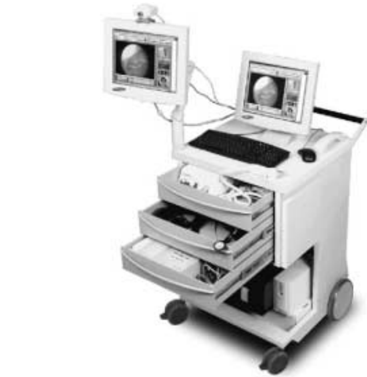
Equipo de Telemedicina que cuenta con estetoscopio, electrocardiograma, dermatoscopio, otoscopio, dentaloscopio y esfigmomanómetro. Permite interacción en vivo con el paciente y el médico.
