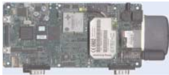
Placa embebida MIP6 de tamaño 161 x 80 mm
